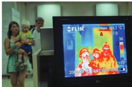
▲ Figura 14 Se usa una cámara térmica para controlar la temperatura de la piel de los pasajeros que llegan al aeropuerto de Nizhny Novgorod, en Rusia. Una elevada temperatura de la piel puede ser indicador de fiebre por alguna enfermedad. Estas cámaras se utilizan de manera generalizada para detectar posibles portadores de diversas gripes epidémicas zoonóticas, tales como la gripe aviar y la gripe porcina.
