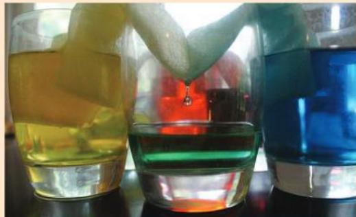
▲ Figura 4 La capacidad de las fuerzas adhesivas para mover el agua se demuestra en esta imagen. Una toalla de papel doblada con un extremo sumergido en agua transportará agua a un recipiente vacío por acción capilar.
