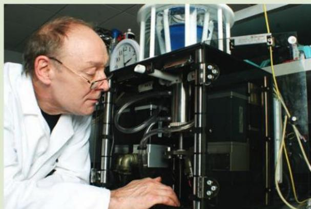
▲ Figura 10 El Modelo Gástrico Dinámico y su inventor, Richard Faulks, ajustando el mecanismo del antro
